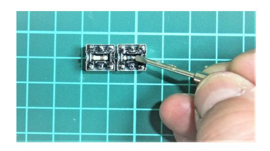
現状では424kHzのみ対応としていますが、IFT内部のコンデンサを写真の様に潰し無効化しコンデンサC2,C3を実装する事で受信周波数を変更することができます。配布部品に120PFを入れていきましたので518kHzにすることは可能です。
